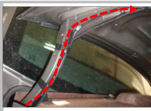
3.8 布线 把2扎布线束(接开关、接门锁信号、)从尾箱左侧沿着摇臂延伸到上门锁(虚线)
