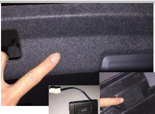
4.3 安装开关按钮：在原车尾门上毛毡板处切割一个长方形孔安装尾门开关按钮；
