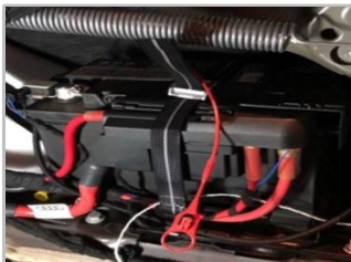
3.16 看到原车尾箱右侧电瓶，我司正极线接原车电瓶正极；
