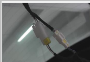
3.12 插头端子连接完成,轻轻摇晃接头,确定线束对接稳固;
