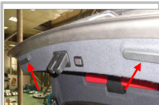
3.4 把撑杆上的塑料件拆下,并妥善保管;
