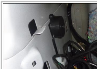
4.4 安装蜂鸣器：与 ECU 接头对接，并把蜂鸣器装在左侧装饰板内空旷处；（箭头）
