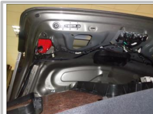
3.7 如图尾箱盖板已取下,盖板妥善保管;
