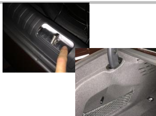
4.5 检查安装的螺钉是否全部锁紧，然后还原后踏盖，内饰毛毡板。
