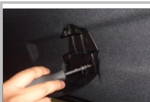
3.6 用螺丝刀把卡扣松开,取下反光条固定件,并妥善保管;
