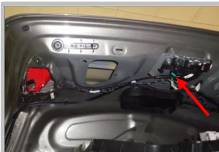
3.13 把信号线引到上门锁扣位置,用与连接原车信号线;
