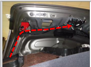
3.9 布线:把2扎布线束(接开关、接门锁信号)延伸到尾箱上门锁扣处,延伸线用胶布或扎带固定好;(虚线)
