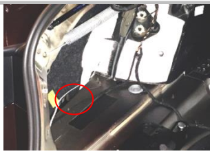
4.2 装 ECU：把 ECU 粘贴在尾箱左侧钣金上，此空旷处（圆圈），固定好防止松动；
