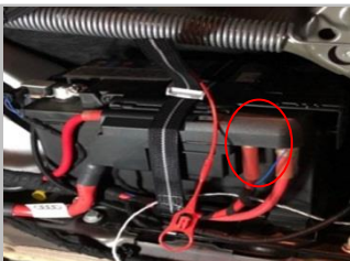
3.17 接正极电源：用我们的正极电源线连接此处电瓶正极“+”（箭头），松动螺母不用拆下，卡紧后再还原拧紧螺母；提示：建议最后连正极取电；
